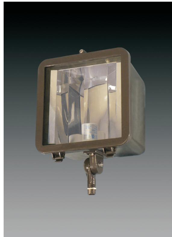
Le projecteur **MULTILUX MT** avec son 'faisceau rectangulaire large' est parfait pour les applications généraux ainsi que pour l'accentuation (facade, enseignes et petit stationnement). Disponible avec montage sur tuyau 1/2 NPT, ou surface plane. Son boîtier en aluminium permet l'utilisation de source "HID" (avec ballast intégré), qui lui procure un faisceau durable et uniforme.
