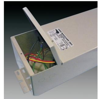
Le Remonte A1 est un boîtier insonorisé pour ballast de type HID "Core & coil" nécessitant une installation intérieure à distance. Compartiments interne pour connexions électriques. S'installe en position horizontale ou verticale sur la plupart des surfaces.
